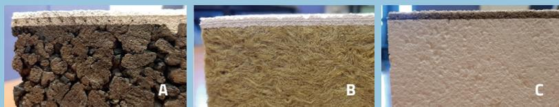
**Figura 8.** Fotografias de três das doze soluções de ETICS utilizadas no estudo com diferente material de isolamento térmico: aglomerado de cortiça expandida – ICB (A), lã mineral – MW (B) e poliestireno expandido – EPS (C).
