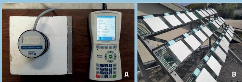
**Figura 9.** Ensaio para a medição da condutibilidade térmica do isolante (A) e estação de envelhecimento natural em ambiente urbano (B).
